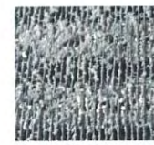
洗浄前 多量のアルミの腐食 生成物が付着
